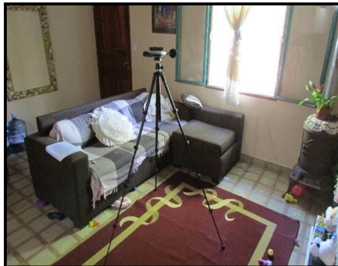
Figura 1: Medición de ruido molesto en interior de vivienda
