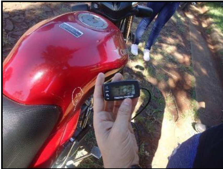
Figura 7: Medidor electromagnético de RPM
