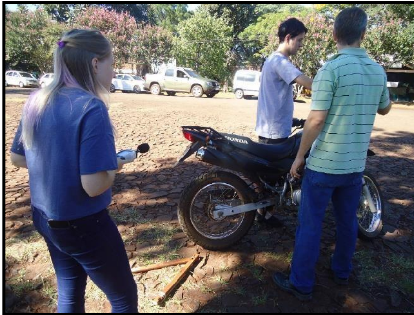
Figura 9: Medición de ruido de escape en motocicletas
