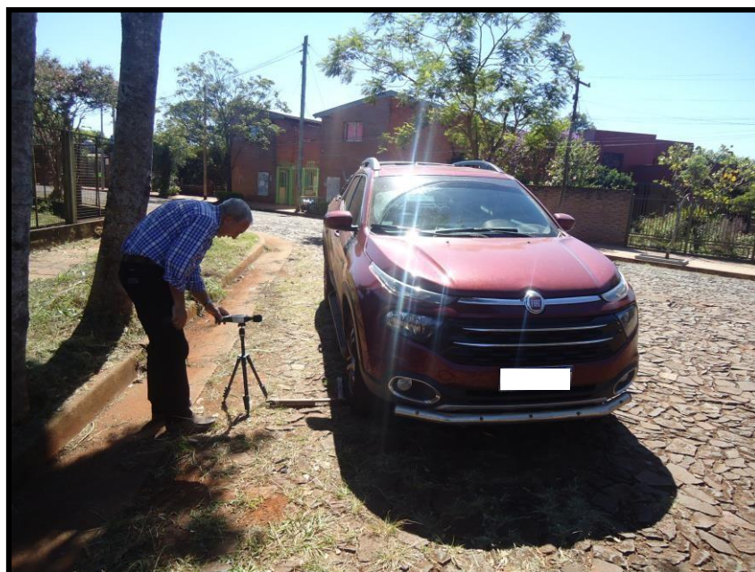
Figura 5: Medición de Ruido de motor en camionetas
