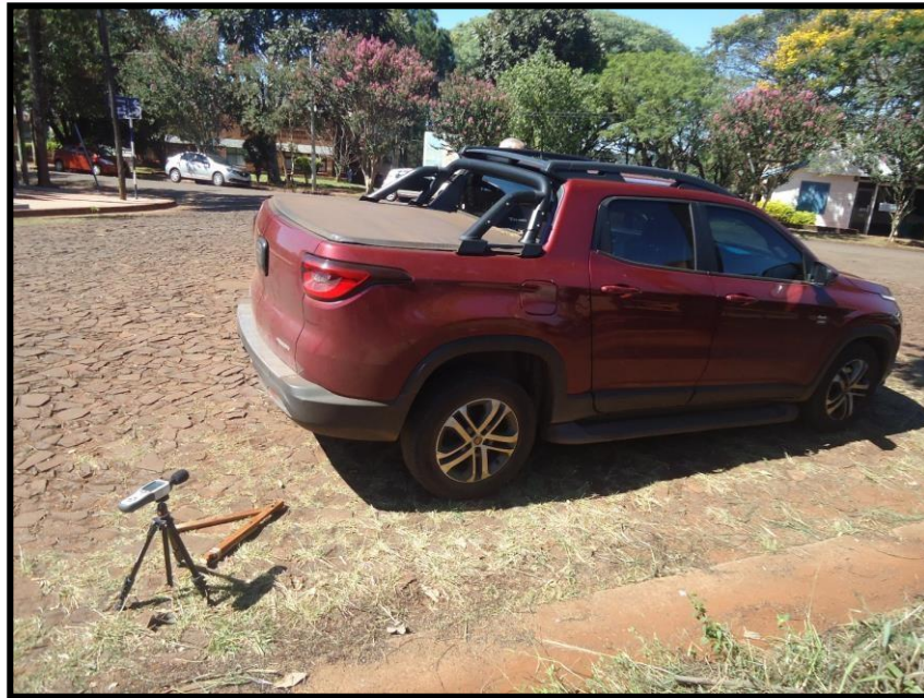
Figura 6: Medición de Ruidos de escape en camionetas
