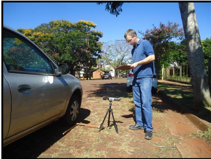
Figura 4: Medición de Ruido de motor en autos
