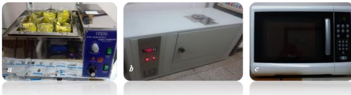
Figura 3.5. Equipamiento empleado para la deshidratación de las frutas: deshidratación osmótica (a), secado convectivo (b), y secado con energía de MW (c)
