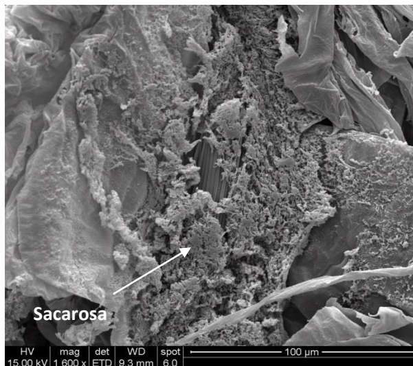
Figura 4.15. Microfotografía de muestra de ananá inmersa en TH CaAA por 3h que ilustra la capa superficial con alto contenido de sacarosa
