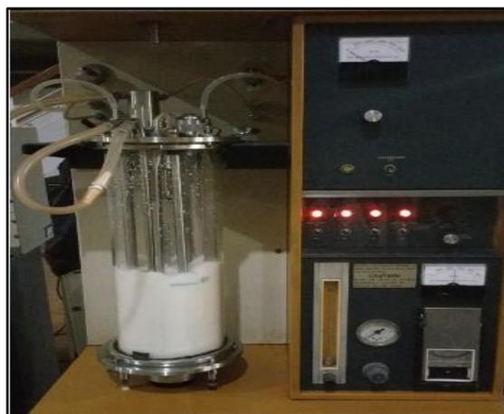
**Figura IV.7:** Extracción enzimática de almidón de mandioca, a escala reactor.
