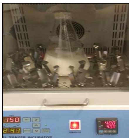
**Figura IV.6:** Extracción enzimática de almidón de mandioca, a escala frascos agitados.
