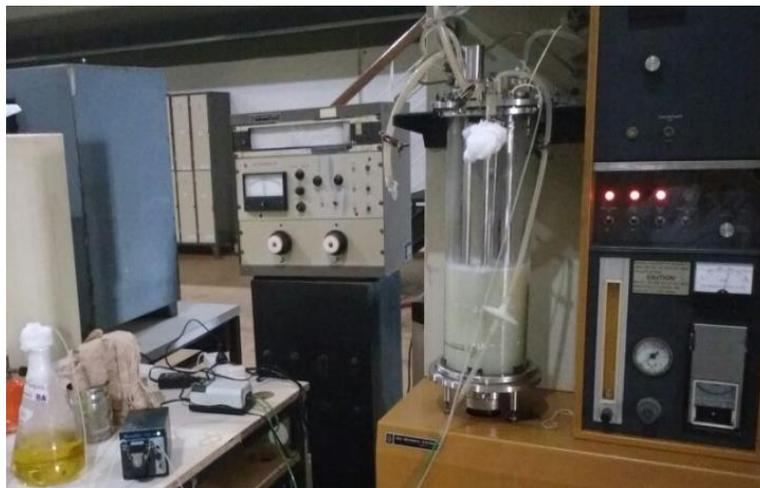
**Figura II.3:** Cultivo batch alimentado para la producción de PGasa por *W. anomalus*, a escala biorreactor.
