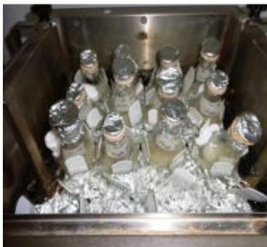
**Figura V.1:** Frascos Erlenmeyer conteniendo la mezcla de reacción (material vegetal +EE+buffer), incubados en shaker rotatorio a 150 rpm.
