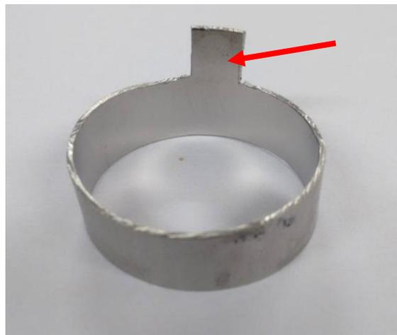
**Figura 6.2:** Fotografía del sustrato con zona de sujeción (flecha).
