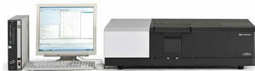
**Figura 3.13:** Espectrofotómetro UV-Vis-IR. Shimadzu UV-3600.
