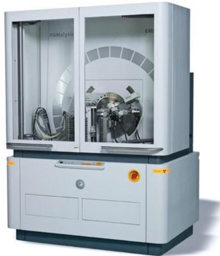
**Figura 3.12:** Difractómetro de Rayos X. Panalytical, Empyrean.
