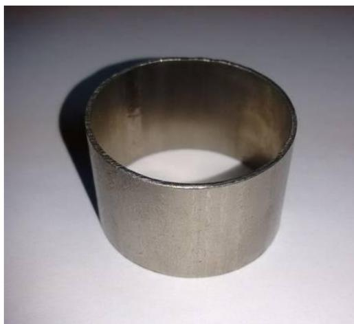
Figura 6.1: Fotografía de un anillo de  $\text{TiG2}$  cortado.
