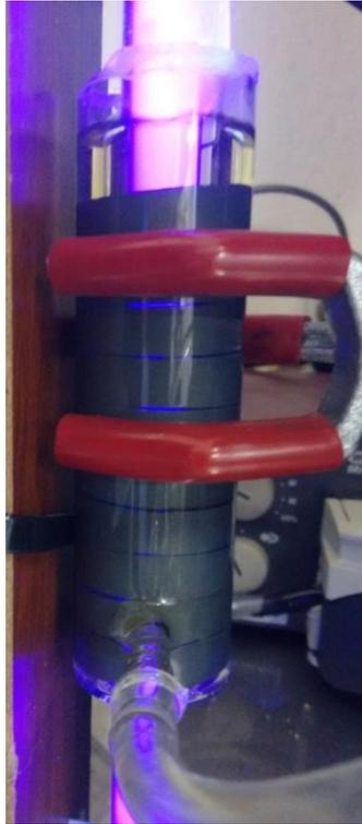
**Figura 6.9:** Fotografía del fotorreactor. Detalle de la ubicación de los anillos. Ensayos de transformación de Cr(VI) en presencia de anillos recubiertos con TiO<sub>2</sub>.
