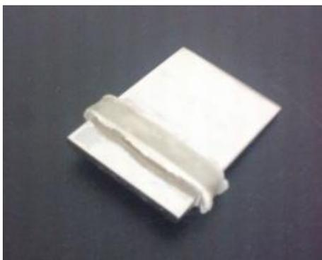
**Figura 3.4:** Sustratos pulidos con barrera de acrílico.
