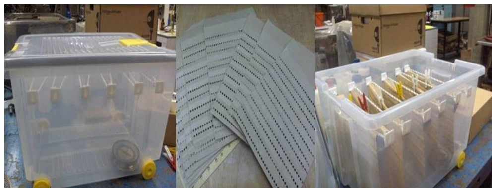
a) b) c) Figura 3.2: a) gabinete hermético, b) sobres perforados y c) gabinete con las muestras expuestas a la silica gel
