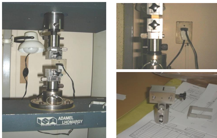
Figura 3.3: Equipo y mordazas para la determinación de Zero-Span Tensile Strength .
