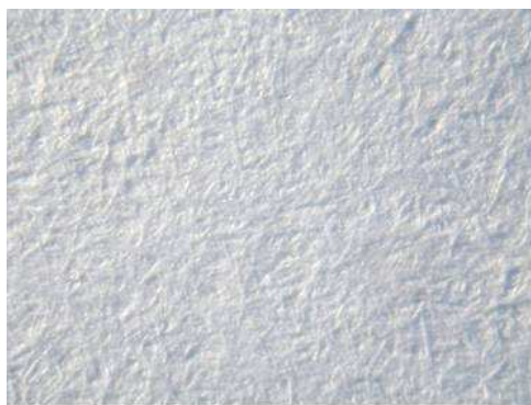
Figura I. 2: Superficie Papel obra NSSC de fábrica (12x)
