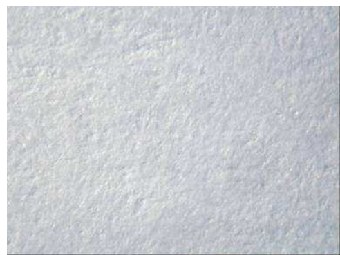
Figura I. 4: Superficie Papel obra NSSC calandrado en laboratorio (12x)
