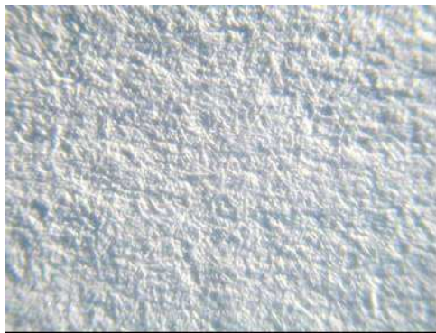
Figura I. 1: Superficie Papel obra NSSC sin calandrar (12x)
