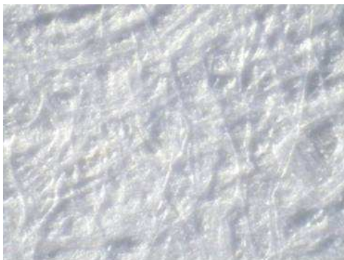
Figura I. 6: Superficie Papel obra NSSC de fábrica (76x)
