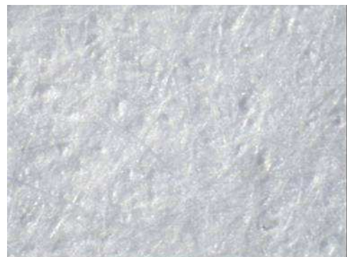
Figura I. 8: Superficie Papel obra NSSC calandrado en laboratorio (76x)
