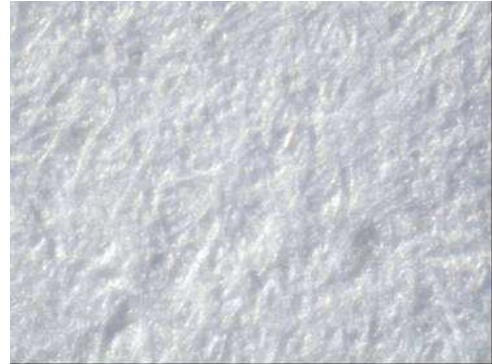
Figura I. 7: Superficie Papel obra testigo de fábrica (76x)
