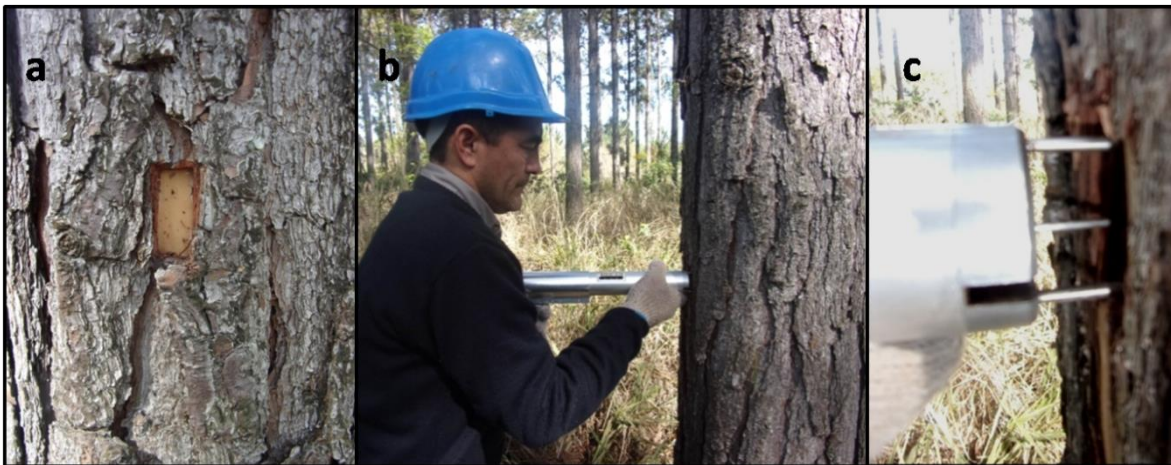
Figura 3.2: Pasos sucesivos para la obtención de datos con Pilodyn 6J Forest
