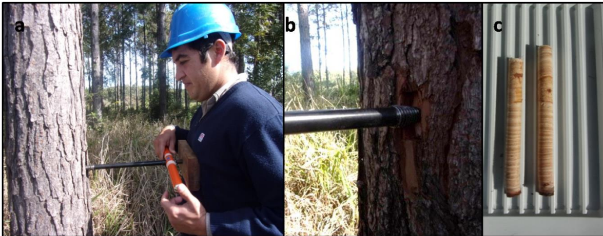
Figura 3.3: Pasos sucesivos para la obtención de tarugos para determinación de densidad básica ( DbT )
