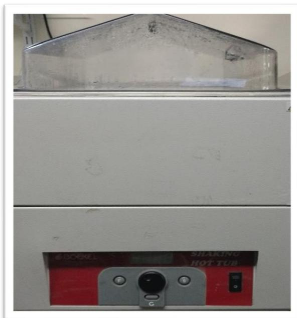
**Figura 24.** Baño húmedo de agitación orbital para colocar hidrolizados de cascarilla de arroz
