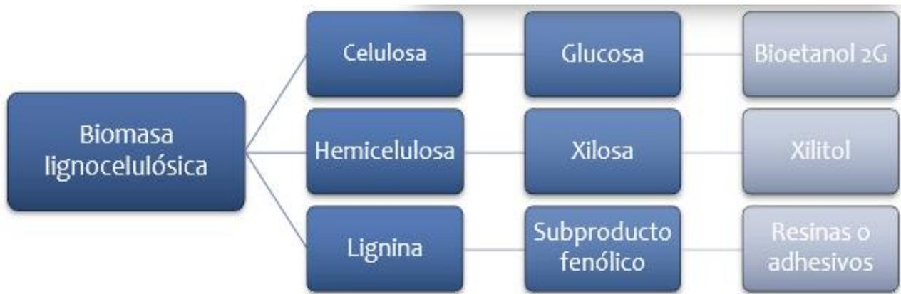
**Figura 9.** Algunos productos que pueden obtenerse a partir de los componentes de la biomasa lignocelulósica (Area y Vallejos, 2012)
