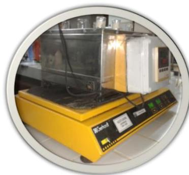
**Figura 22.** Agitador de vaivén para hidrólisis y fermentación (SSF).
