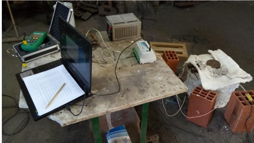
Figura 2.10 - Sistema de adquisición de datos y horno de precalentamiento. (Imagen obtenida por el autor)
