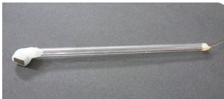
Figura 3.4 - Confección de electrodo de trabajo. (Imagen obtenida por el autor)
