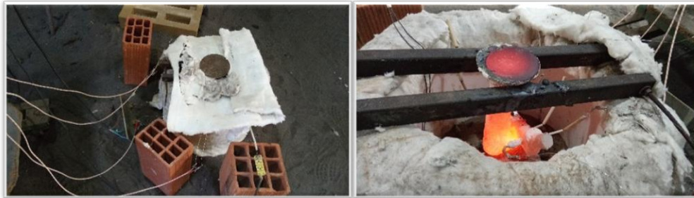
Figura 2.8 – Disposición de las termocuplas en el horno de precalentamiento. (imágenes obtenidas por el autor)
