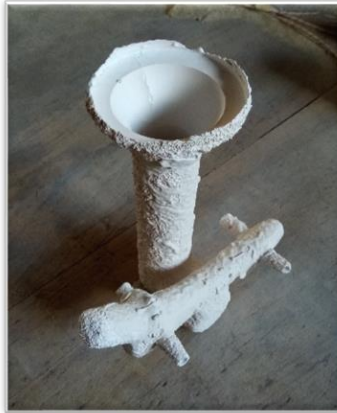
Figura 2.12 - Molde con diseño por surgencia. (Imagen obtenida por el autor)
