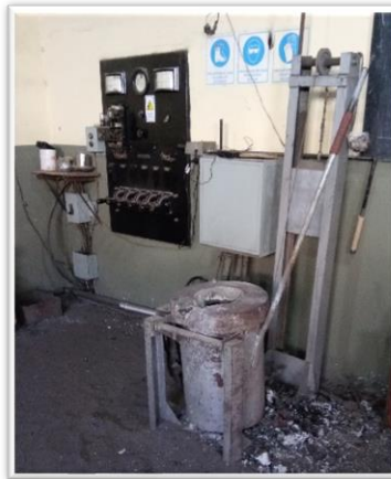
Figura 2.7 - Horno de inducción. (Imagen obtenida por el autor)
