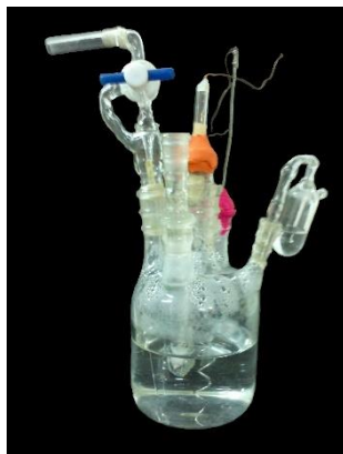
Figura 3.5 - Celda electroquímica. (Imagen obtenida por el autor)
