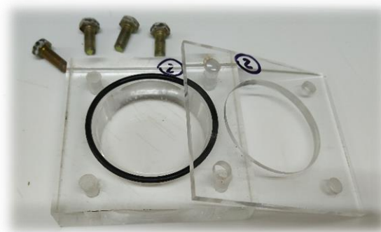
Figura 4.2: Celdas utilizadas para las determinaciones de permeabilidad al vapor de agua
