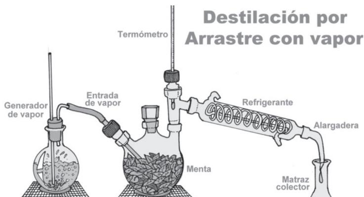
**Figura 6:** Instalación experimental para la extracción de aceites esenciales: destilación por arrastre de vapor.
