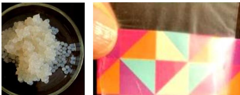
**Fig. 1. Esferas y filme de celulosa regenerada obtenidas**
