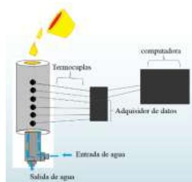
Fig. 2. Esquema del dispositivo experimental empleado para la solidificación direccional.
