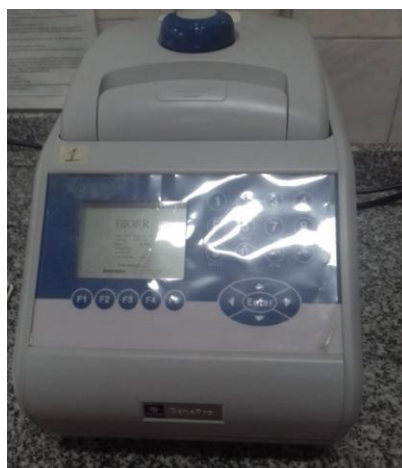
Figura Nro. 16: Termociclador Equipo Hangzhou Bioer Technology Co., Ltd. Life Express Thermal Cycler
