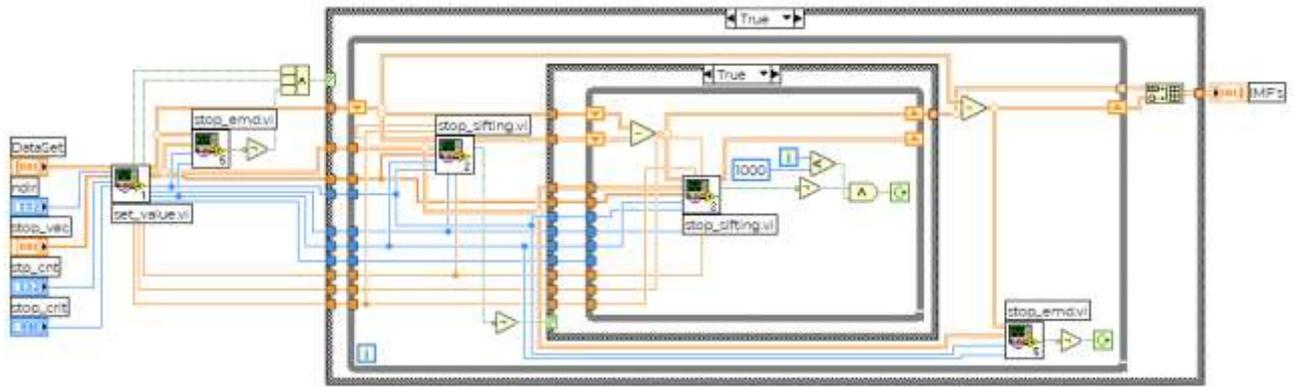
**Fig. 8. Algoritmo MEMD en LabVIEW**
