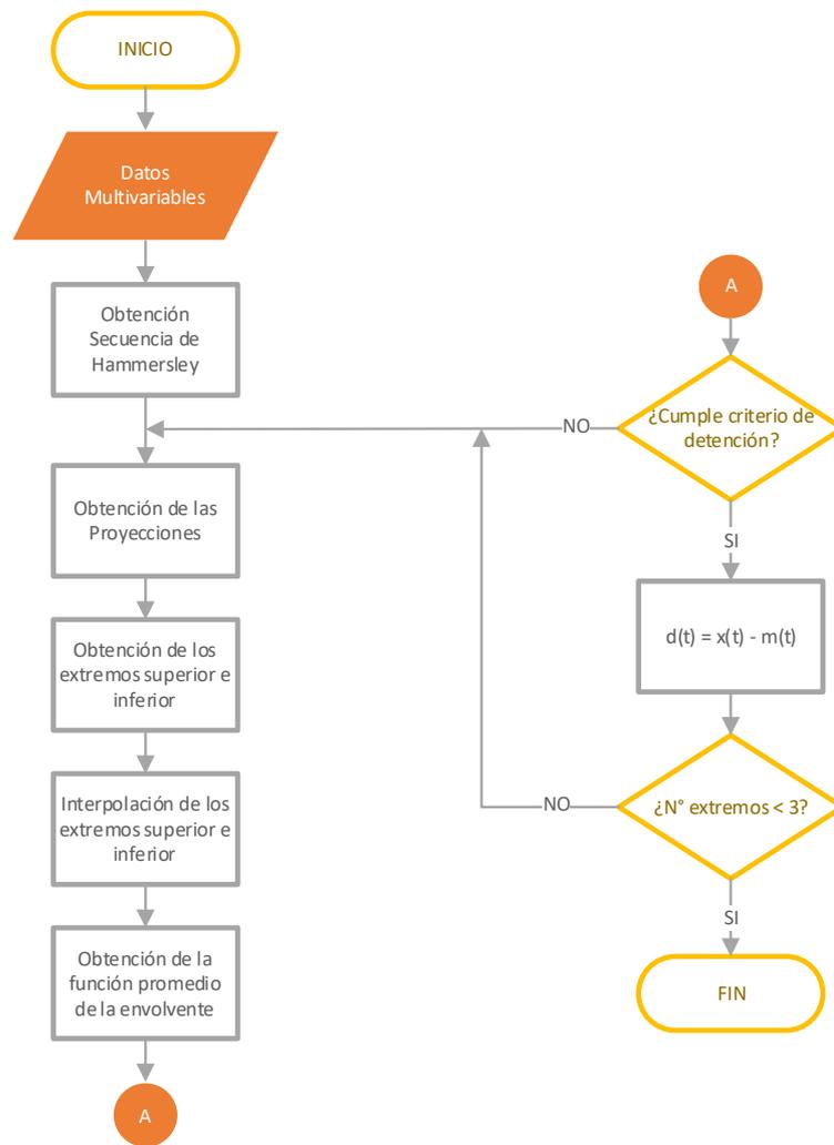
**Fig. 7. Diagrama en bloques básico del algoritmo MEMD.**
