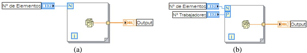
Fig. 4. (a) Bucle *for* sin ejecución en paralelo. (b) Bucle *for* configurado para ejecutarse de forma paralela con N trabajadores.
