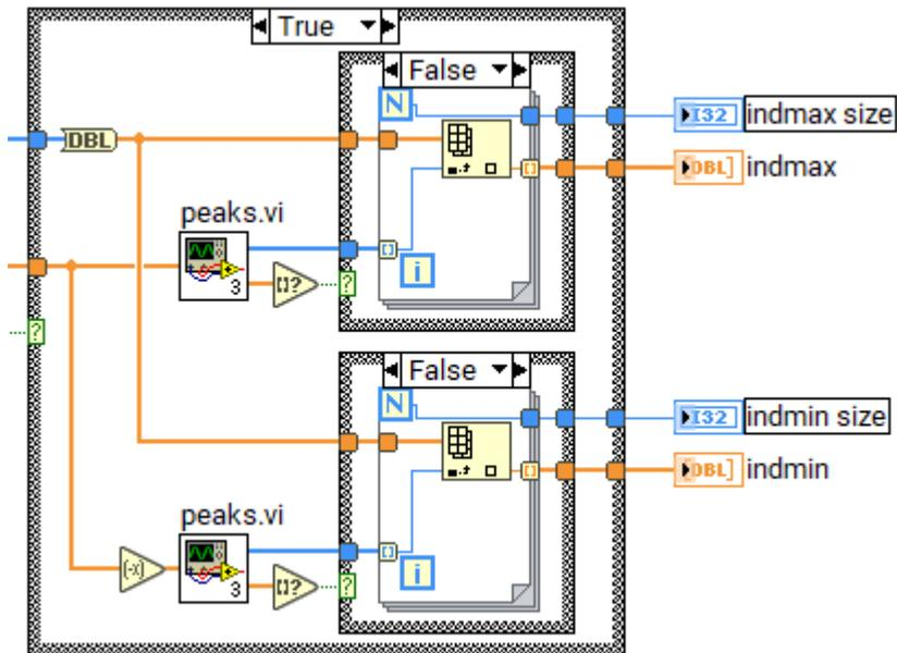
**Fig. 11. Cálculo de los extremos superior e inferior.**
