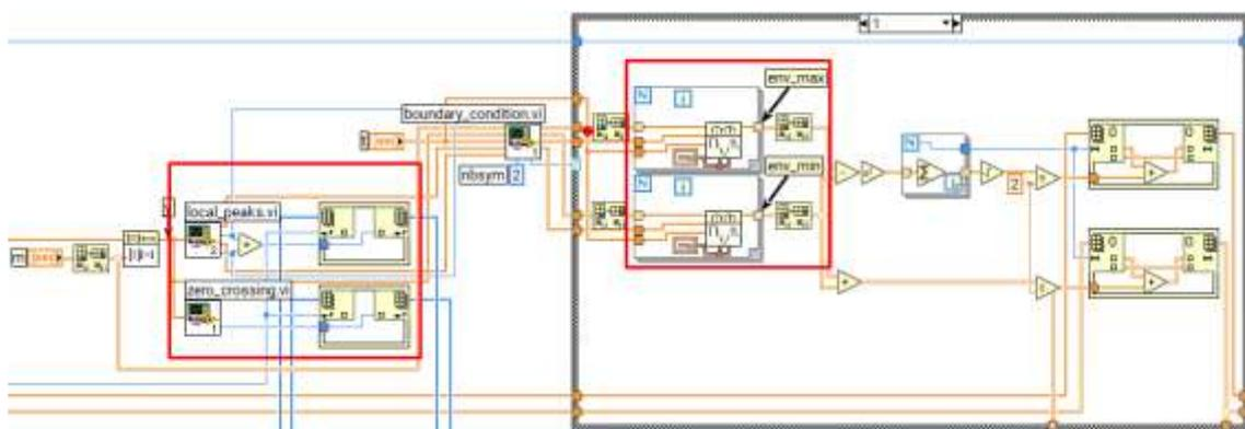
**Fig. 10. Algoritmo con el cual se obtiene el vector dirección a partir de la secuencia de Hammersley.**
