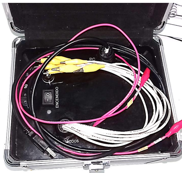
Fig. 8. Prototipo del adquisidor totalmente ensamblado.
