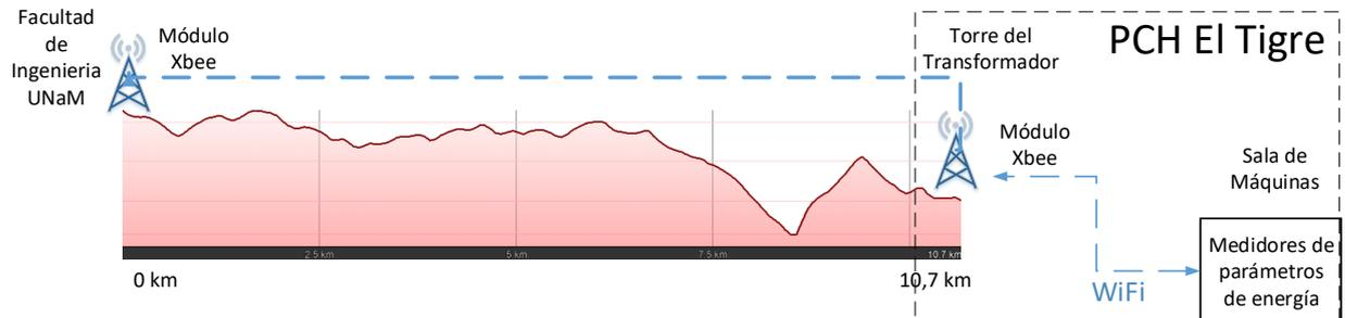
Figura 9 - Esquema de la alternativa con Xbee
