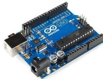
**Figura 7 - Foto ilustrativa de Arduino UNO**
