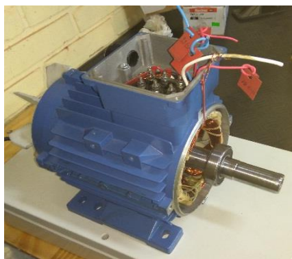
Fig. 3 – Prototipo de MER desarrollada en el laboratorio
