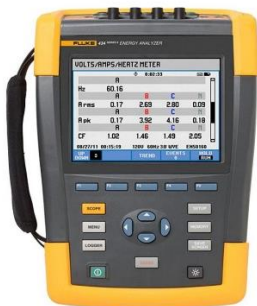
Fig. 7 – Analizador de calidad de energía Fluke 434
