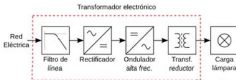
Figura 3: diagrama de bloques del transformador electrónico
