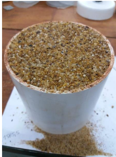
Fig. 3(b). Armado de filtro capa 2.
