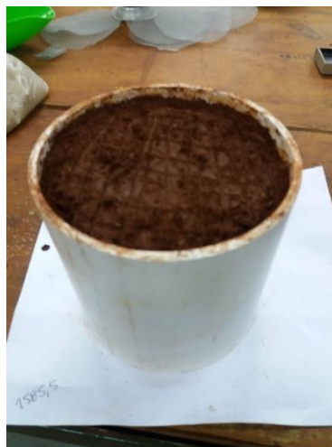
Fig. 2. Suelo compactado en probeta.
