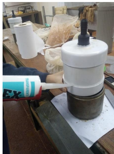
Fig. 4. Sellado de probeta.
