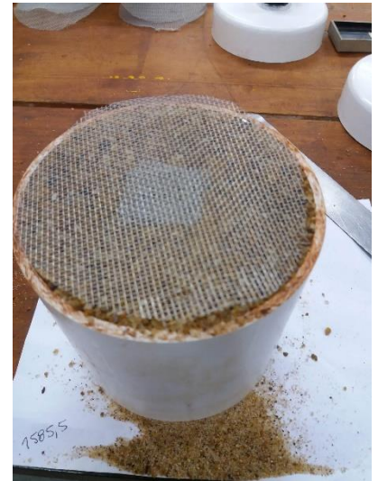
Fig. 3(c). Armado de filtro malla.
