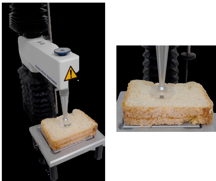
Figura III-2. Analizador de textura y posición del émbolo sobre dos rebanadas superpuestas.
