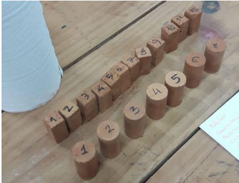
Figura 1. Ensayo de resistencia a Compresión en probetas de cerámica.
