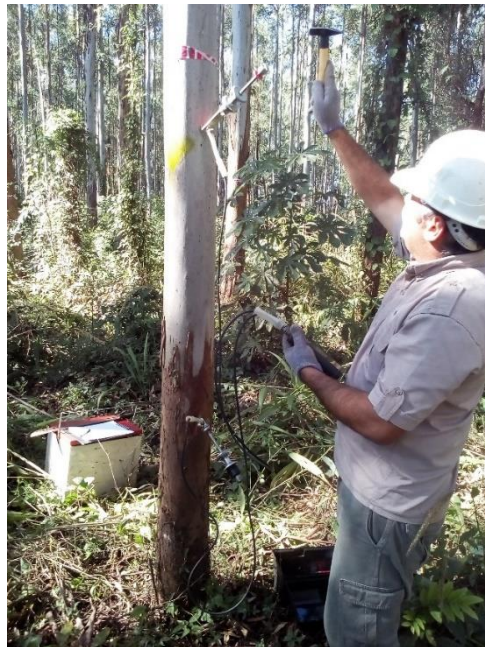
Anexo 4. Medición del tiempo de traslado de una onda de impacto de los árboles en pie con el equipo Tree Sonic (Fakopp®).
