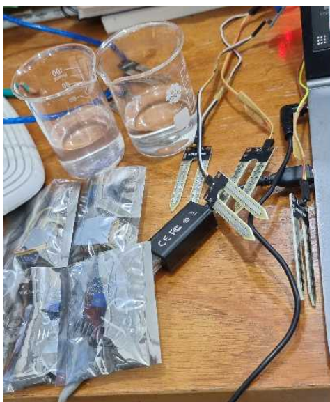
Figura 57: Cambio de sensores YL69
