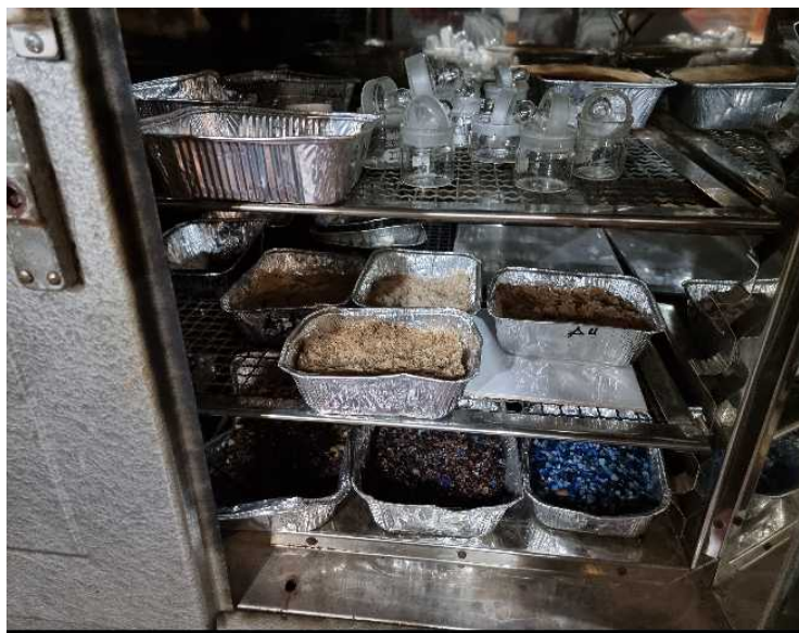
Figura 52: Eliminación de la humedad en la arena por medio del secado al horno
