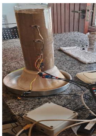
Figura 69: Perfil de suelo ARENA con sensores sin agua, con caja estanco
