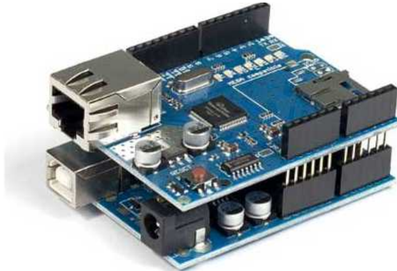
Figura 39: Conexión Ethernet Shield al Arduino Uno fuente: https://acortar.link/ceHOIj
