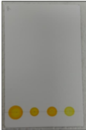
Figura 5. Placa cromatográfica con aplicación de muestra y estándares, previa al desarrollo. Se observa la línea de siembra sobre la fase estacionaria (gel de sílice GF).
