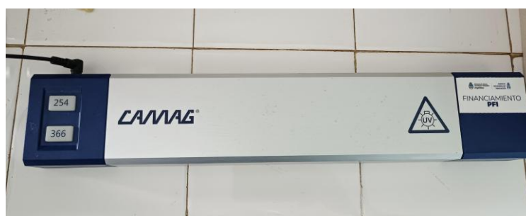
Figura 17. Lámpara de luz ultravioleta CAMAG utilizada para la observación de las placas cromatográficas a 254 nm y 366 nm.
