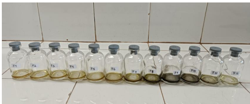
Figura 12. Reconstitución de las fracciones secas con metanol. Fracciones F1 a F12 reconstituidas con 1 mL de metanol, representativas del total recolectado (F1–F23), previo al análisis por cromatografía en capa fina. Nota. Fotografía de la autora (2025).
