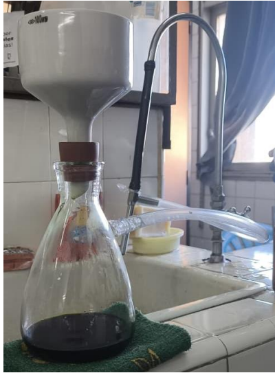
Figura 14: Filtrado al vacío, con Kitasato de extracto crudo de hoja de Nicotiana glauca. , foto de autora.
