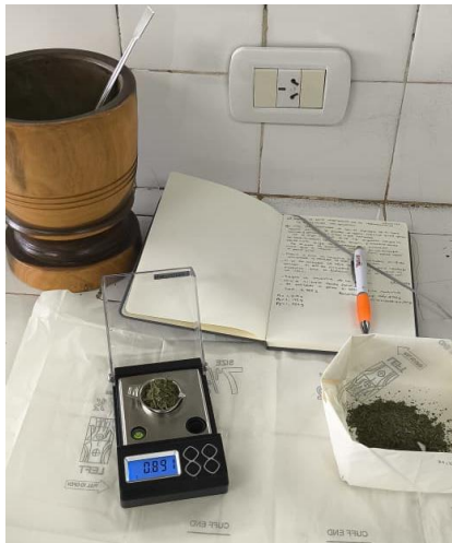
Figura 11: Pesado de molienda de muestra hojas para extracto seco. Foto de autora.
