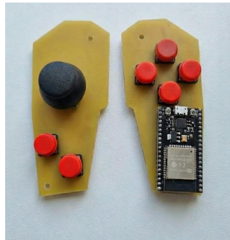
Imagen N° 20: Diseño y resultado obtenido del circuito impreso del gamepad.
