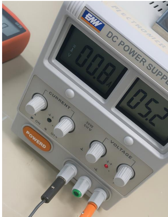
Imagen N° 13: Prueba de laboratorio para la determinación del consumo de corriente del ESP-32.
