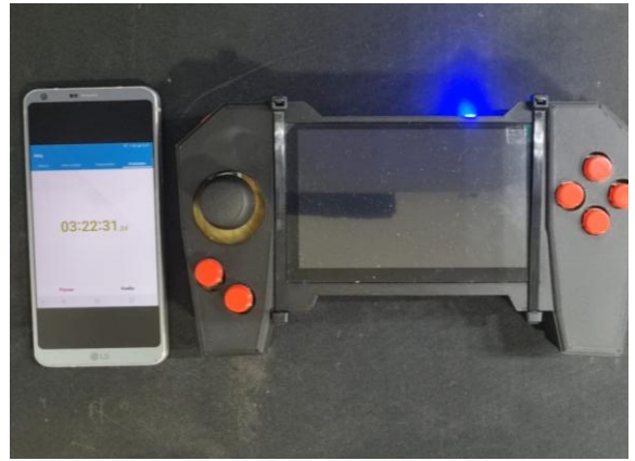
Imagen N° 43: Pruebas de duración de la batería.
