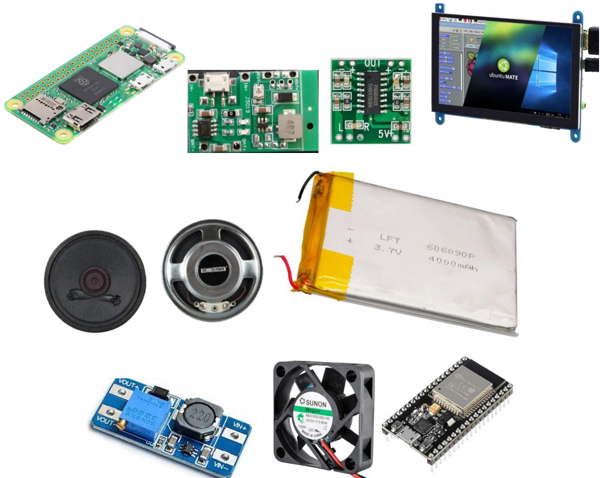
Imagen N° 15: Componentes utilizados: Raspberry Pi Zero 2W[59], TP 4056[60], PAM 8403[61], Display 5''[62], Parlantes[63], Batería[64], MT3608[65], Ventilador[66], y ESP-32[67].
