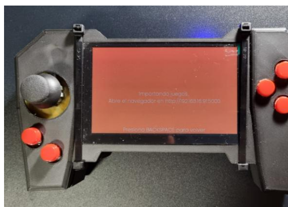
Imagen N° 29: Carga de una ROM desde el servidor de Flask.
