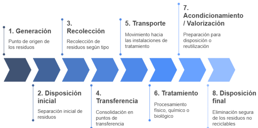
Figura 1.7: Esquema de la GIRSU según la Ley N° 25.916/2004 “Gestión de residuos domiciliarios” y sus decretos reglamentarios. Fuente: adaptado de Tchobanoglous (2002) y ENGIRSU (2006).
