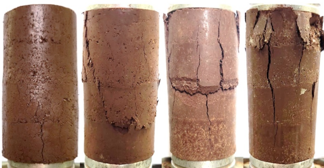
Fig. 11. Imágenes fotográficas de probetas ensayadas a día 28 (0%, 4%, 6% y 8% de contenido de cemento).
