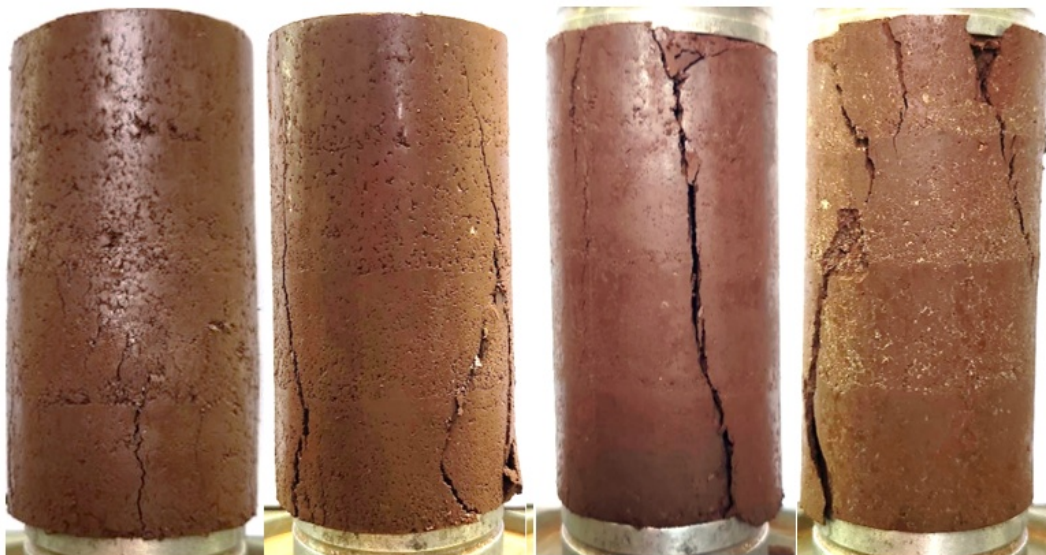
Fig. 5. Imágenes fotográficas de probetas ensayadas a día 1 (0%, 4%, 6% y 8% de contenido de cemento).
