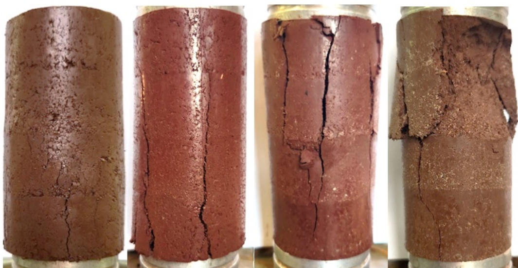
Fig. 7. Imágenes fotográficas de probetas ensayadas a día 7 (0%, 4%, 6% y 8% de contenido de cemento).
