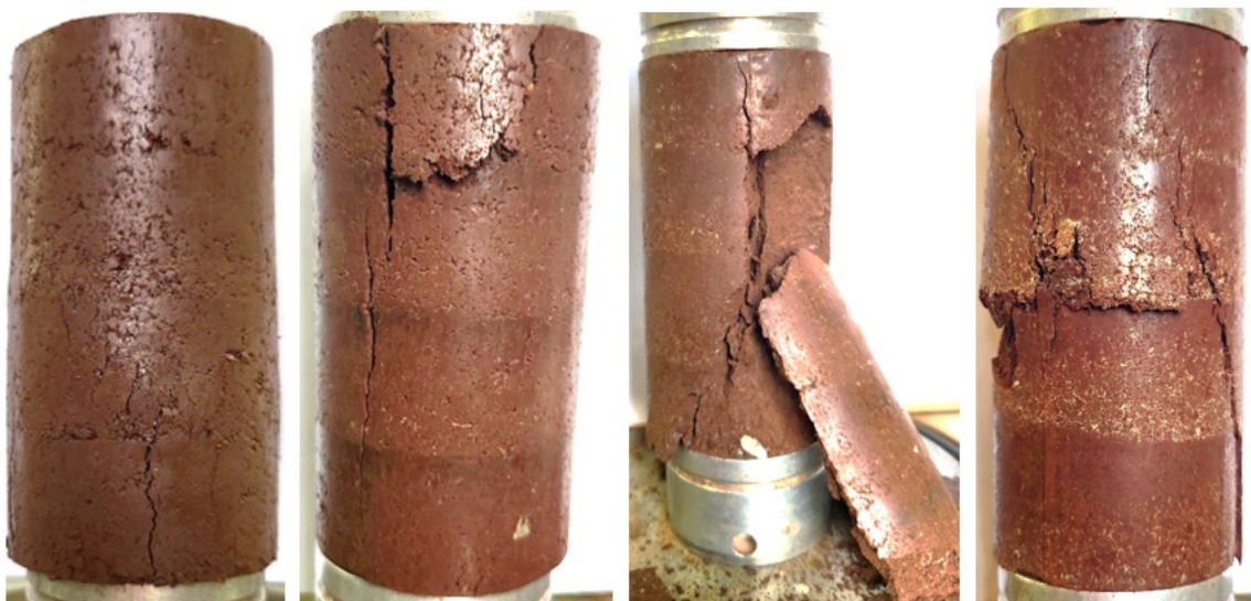
Fig. 9. Imágenes fotográficas de probetas ensayadas a día 14 (0%, 4%, 6% y 8% de contenido de cemento).
