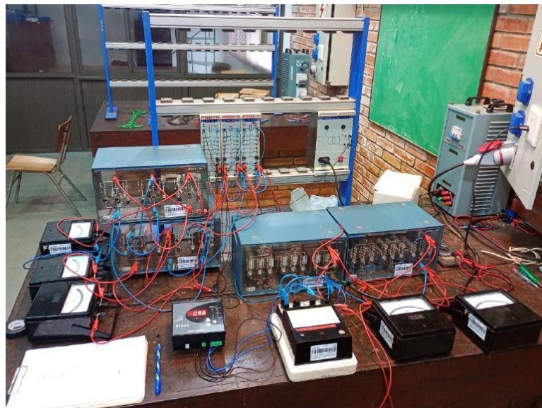
Fig. 5. Ensayo de sensibilidad sobre el relé varimétrico.
