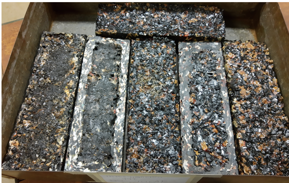
Fig. 5. Preparación de los prototipos para el ensayo de absorción.
