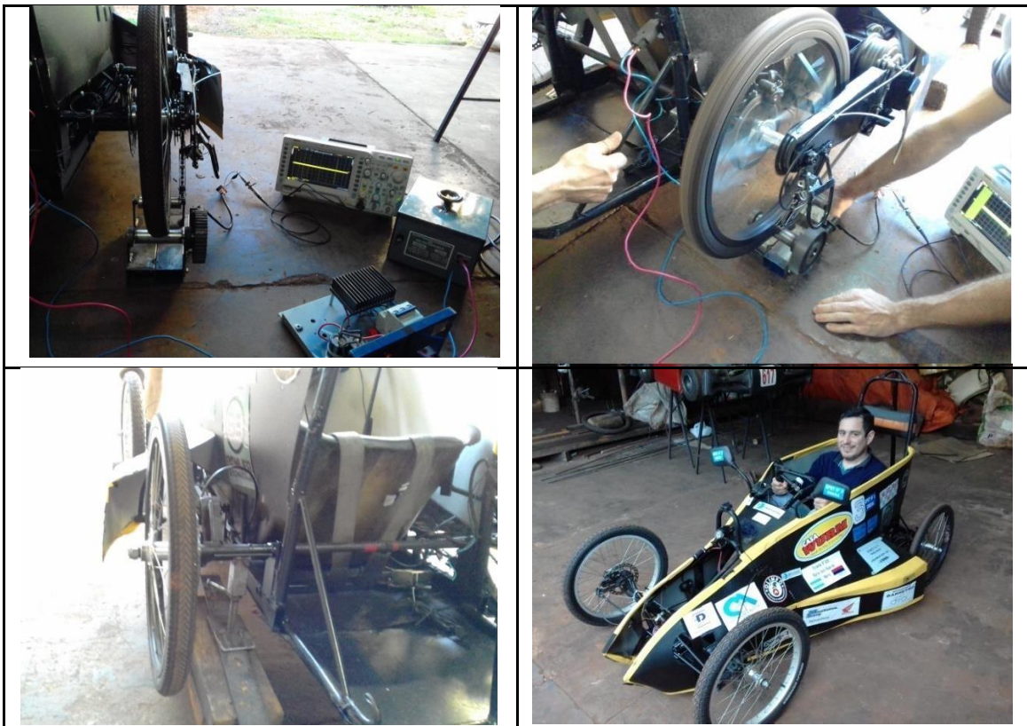
Fig. 9: Ensayos correspondientes a la medición de torque en el eje del motor, se utilizó un primer prototipo de banco de prueba. Gentileza auto de la EPET N°3 Polonia.
