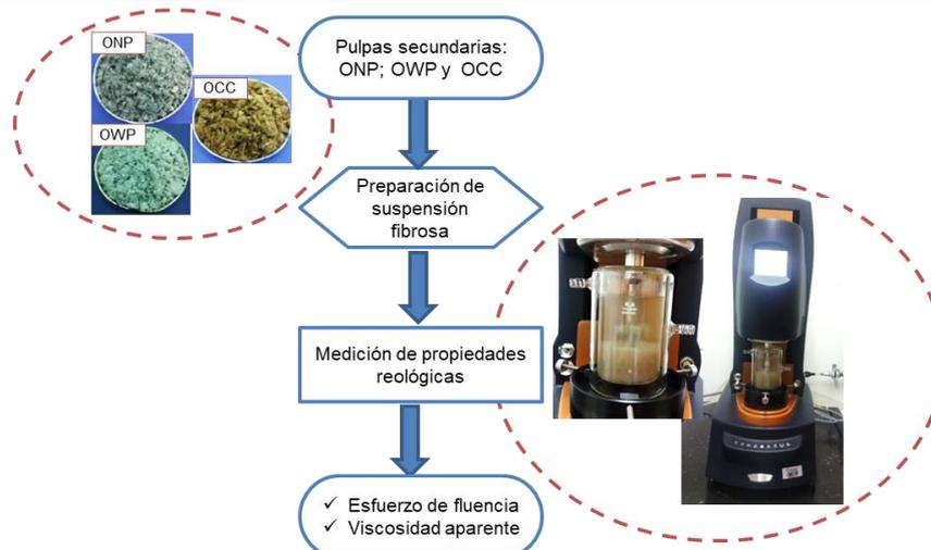
**Figura III.10.** Diagrama de flujo del procedimiento de evaluación de parámetros reológicos
