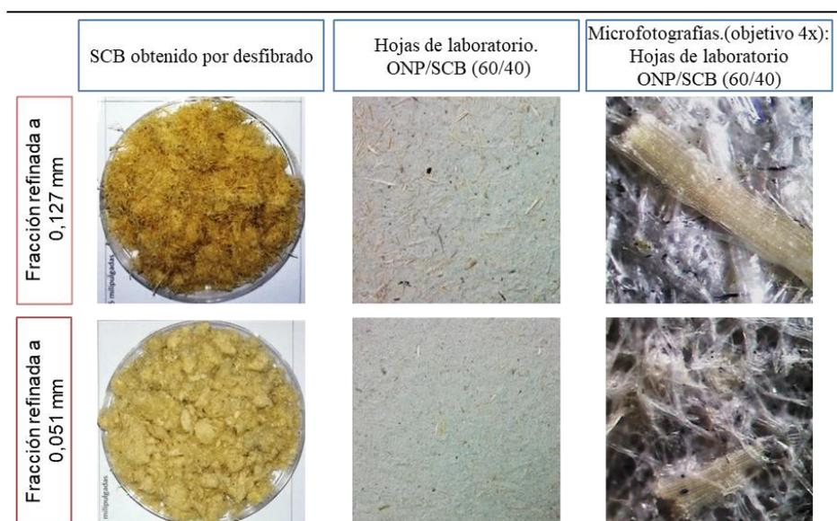
**Figura III.5.** Microfotografías de hojas de laboratorio a base de mezclas de ONP/SCB
