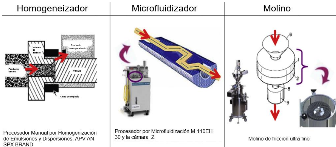
Figura 14: Equipos más utilizados para la fabricación de celulosa microfibrilada mediante tratamiento mecánico. “Microfluidizador: patente de los Estados Unidos Matsuda. Ueno, y Hirose (2001)”, (Extraída y modificada de (141))
