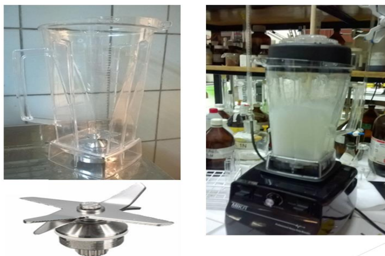
Figura 18 : Equipo de alto esfuerzo de corte marca Mika
