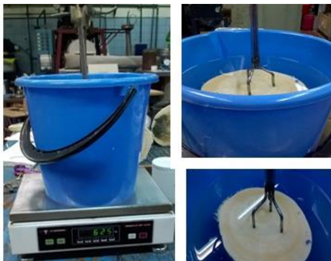
Figura 31: Determinación de densidad de la madera (norma TAPPI T 258 om-94)
