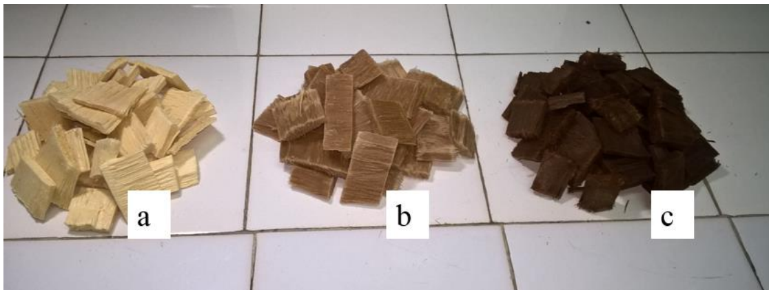
Figura 65: Aspecto y coloración de los chips de MO y de las muestras obtenidas en las etapas de tratamiento secuencial: a) Chips de MO, b) AC y c) AC/HT
