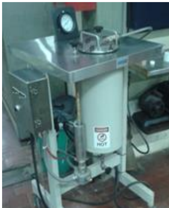
FIGURA 3.1 REACTOR DE COCCIÓN 7 L DE CAPACIDAD
