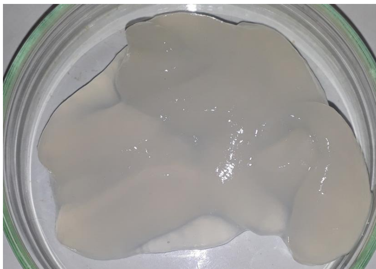
FIGURA 4.14 HIDROGREL DE LNFC PROVENIENTE DE PULPA KRAFT BLANQUEADA UTILIZANDO FIBRILACIÓN MECÁNICA CON MOLINO COLOIDAL
