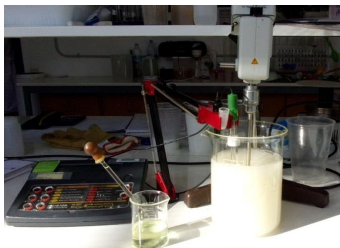
FIGURA 3.3 OXIDACIÓN TEMPO A PH 10.
