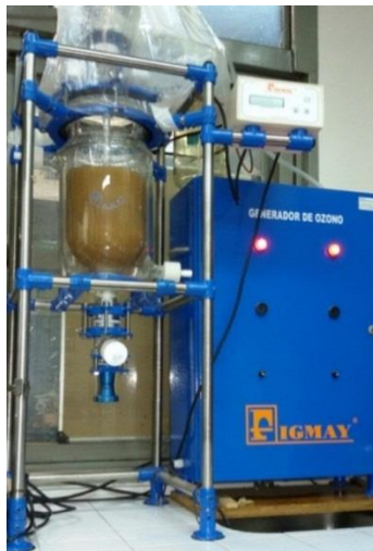
FIGURA 3.2 REACTOR DE OZONO
