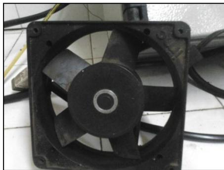
**Figura III-6:** Ventilador de flujo axial utilizado para la circulación del aire y vapor dentro de la cámara
