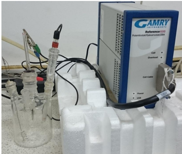
Figura 5.7: Potenciostato Gamry Reference 600® conectado a la celda electroquímica.
