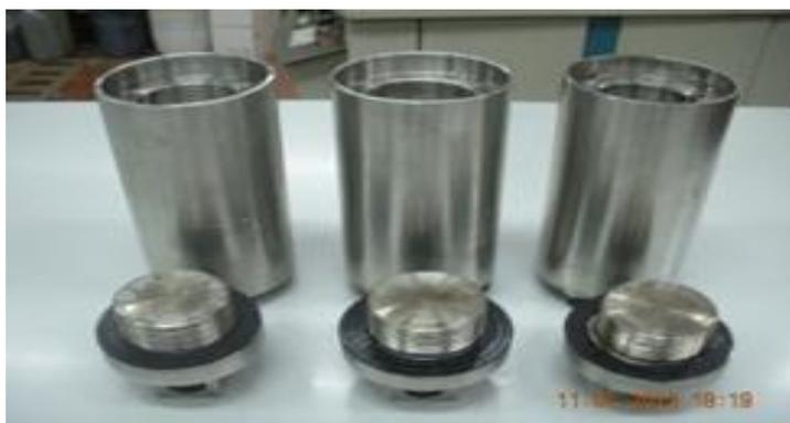
**Figura 14.** Reactores empleados en los tratamientos soda- etanol.
