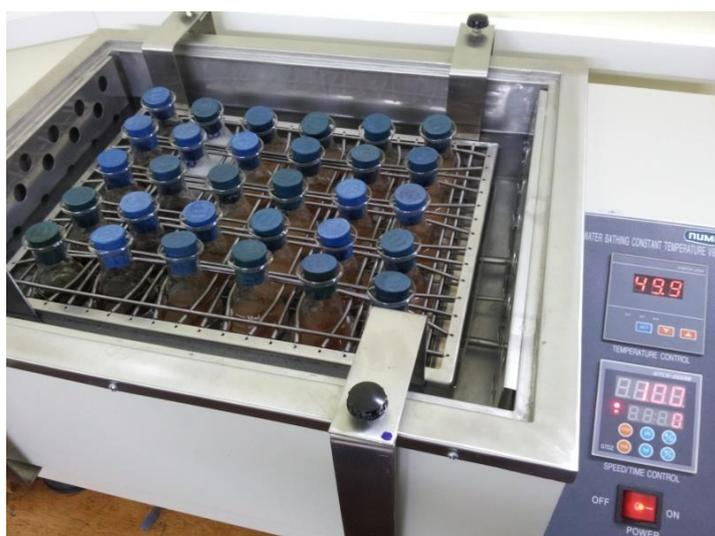
**Figura 18.** Hidrólisis enzimática en proceso.
