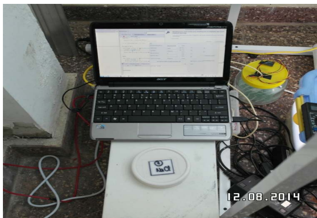
Figura 3.13. Sistema de calibración de humedad del sensor DHT22
