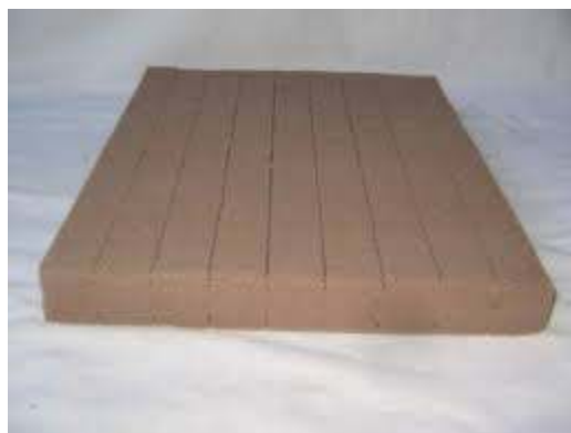
Figura 3.3. Plancha de espuma fenólica pre moldeada
