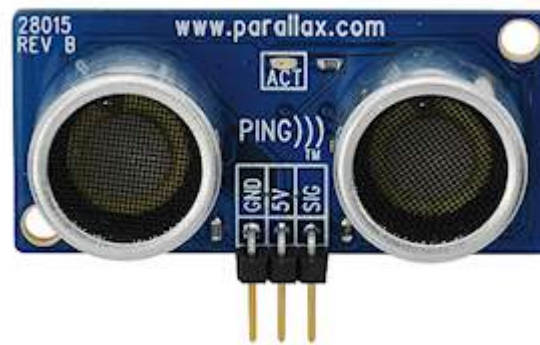
Figura 4.9. Medidor de distancia por ultra sonido tipo "PING"
