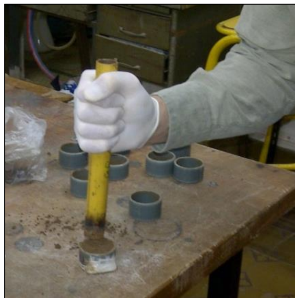
Figura 3.10: Compactado del suelo disturbado
