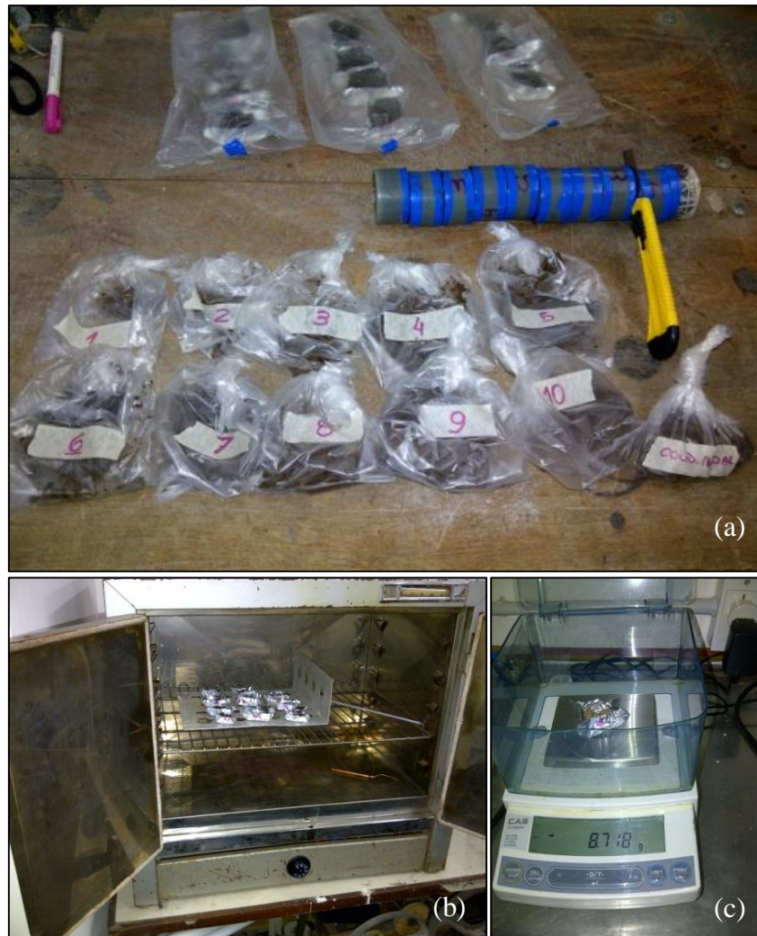
Figura 3.12: a) Desmontado de la columna y toma de muestras. b) Secado de muestras. c) Pesado de muestras
