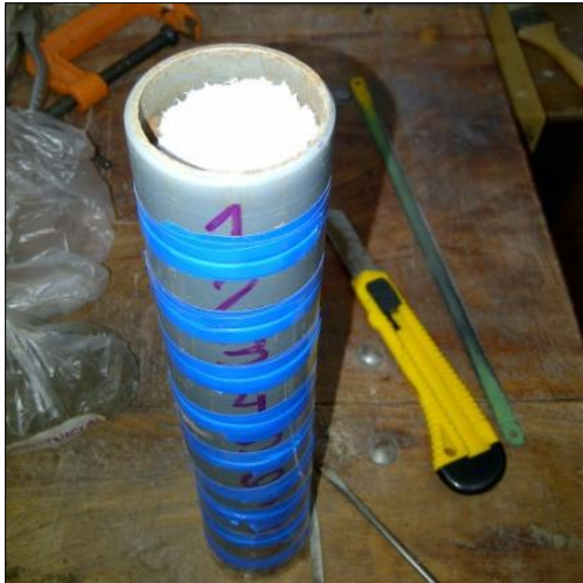
Figura 3.11: Columna preparada para el proceso de infiltración
