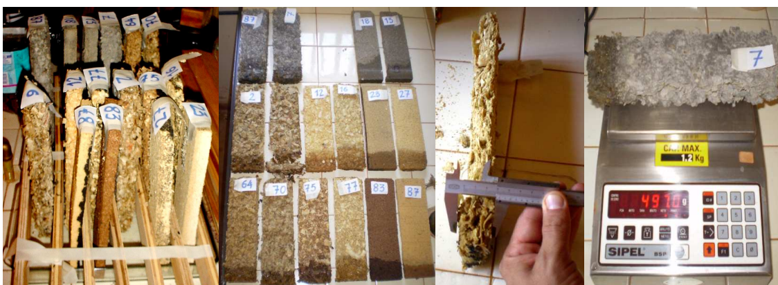
Probetas en bandeja c/agua 5cm Medición de capilaridad Medición de hinchamiento Determinación de absorción
