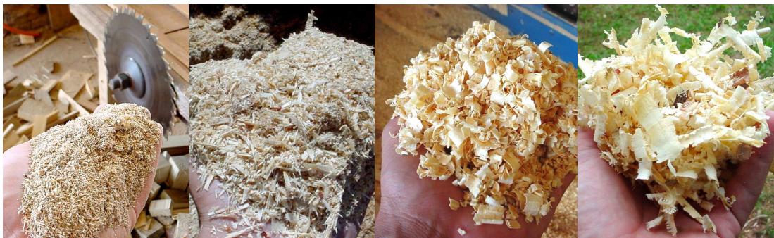
Aserrín seco sierra circular Aserrín verde Sierra Sinfín Viruta seca Moldurera Viruta seca Garlopa
