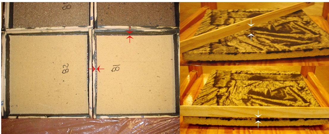
Retracción lateral por fragüe de adhesivo probeta D3
