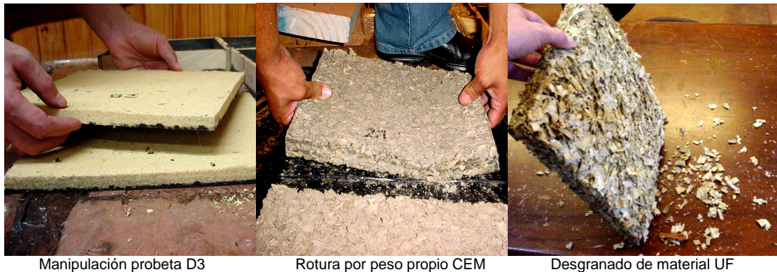
Foto 23 Método para determinar comportamiento al manipuleo. (CELANO 2005)
