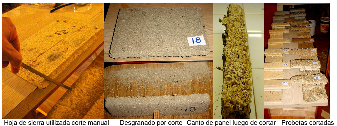
Hoja de sierra utilizada corte manual Desgranado por corte Canto de panel luego de cortar Probetas cortadas
