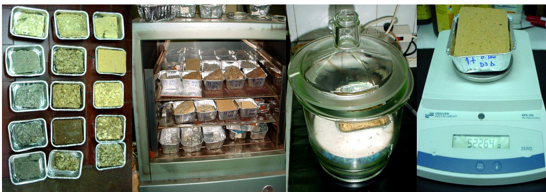
Medición peso húmedo Estufa a 105°C por 24hs Vaso para enfriado seco Medición peso seco
