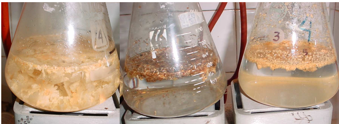
Viruta suelta sin adhesivo absorción de agua homogénea
