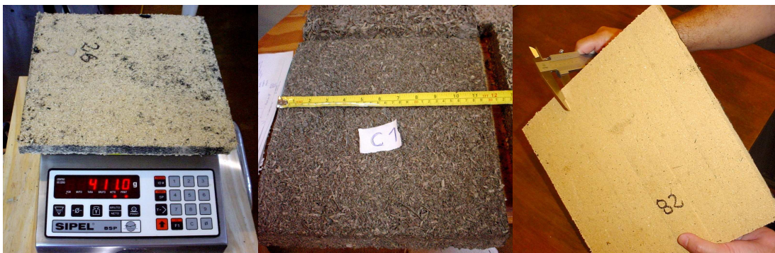
Foto 17 Determinación de densidad de probetas. (CELANO 2006)
