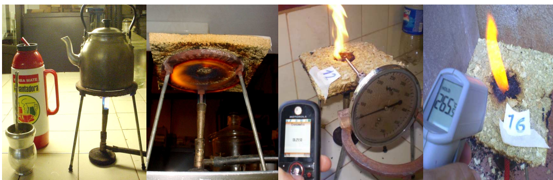
Mechero de laboratorio Posición de probeta a 5cm Tiempo ignición espontánea Tiempo de atravesar el panel
