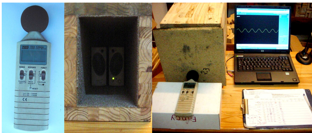
Decibelímetro digital Caja acústica con parlantes Medición sonora con software de sonido frecuencia 1000hz
