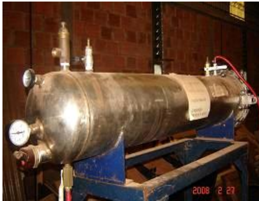
Imagen 5. Autoclave para impregnar. Fuente: Cátedra de Tecnología de la madera, FCF.
