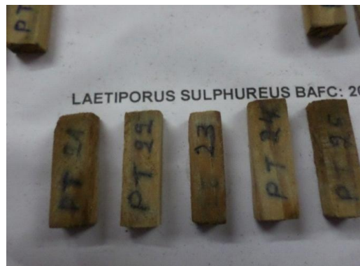
Imagen 25. Probetas de madera de Pinus taeda impregnada con CA-B después de la acción del hongo Laetiporus sulphureus .
