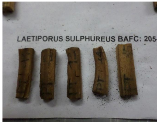
Imagen 24. Probetas de madera de Pinus taeda sin impregnar después de la acción del hongo Laetiporus sulphureus .
