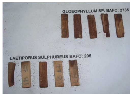
Imagen 26. Probetas de madera de Bastardiopsis densiflora sin impregnar después de la acción de los hongos Gloeophyllum sp. y Laetiporus sulphureus .
