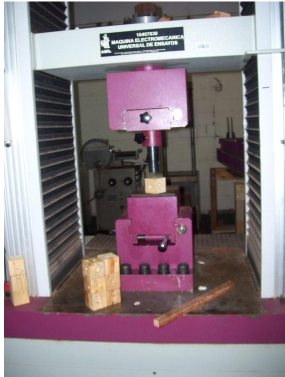
Imagen 15. Máquina Universal de Ensayos. Fuente: Laboratorio de Tecnología de la madera, FCF.
