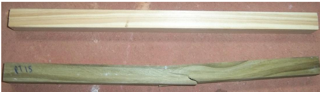
Imagen 21. Probetas de madera de Pinus taeda sin impregnar (arriba) e impregnada con CA-B y posterior al ensayo de flexión estática (abajo).
