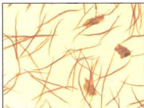
Foto N° III.2: Material fibroso retenido en malla 14 correspondiente a la pulpa de bagazo de caña de azúcar, primer uso (objetivo 4X)
