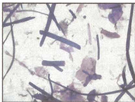
Foto N° III.6: Material fibroso correspondiente a la pasta de de bagazo de caña de azúcar, tercer uso (objetivo 20X)
