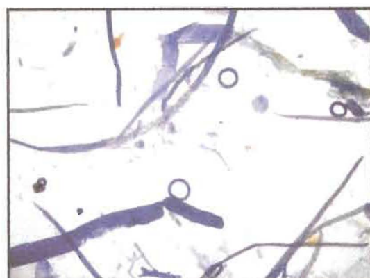
Foto N° III.4: Material fibroso correspondiente a la pasta de bagazo de caña de azúcar, segundo uso (objetivo 20X)
