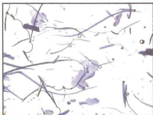
Foto N° III.3: Material fibroso correspondiente a la pasta de bagazo de caña de azúcar, segundo uso (objetivo 10X)
