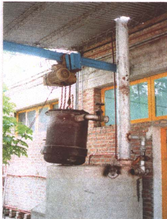
Foto 2.6: Extracción de la retorta del horno de calefacción
