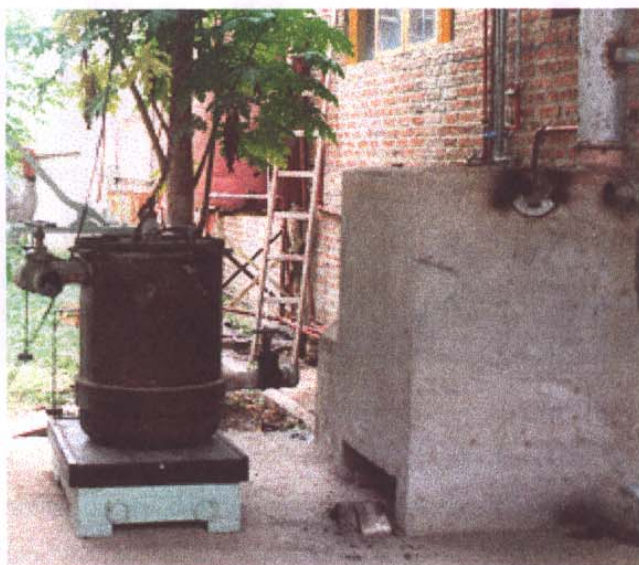
Foto 2.3: Retorta vertical y horno de calefacción
