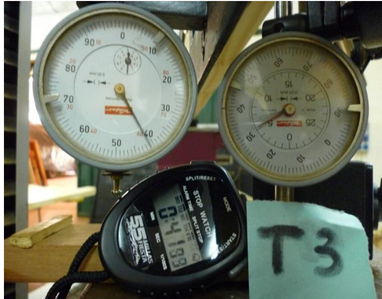
Foto 15: Determinación de f_1 y f_2 utilizando comparadores con apreciación de 0,01 mm
