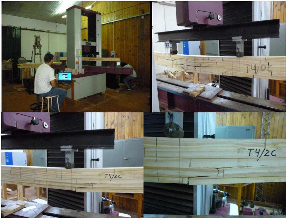
Fotos 14: Ensayo típico de flexión estática de una viga
