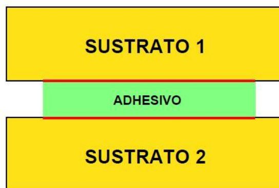
Figura 11: Esquema básico de una unión mediante adhesivo. Fuente: (30)
