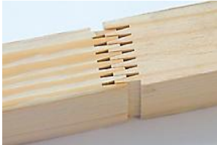
Foto 4: Finger – joint para el armado de láminas
