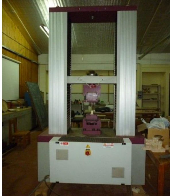
Foto 16: Máquina Electromecánica Universal, con una capacidad de 300 kN
