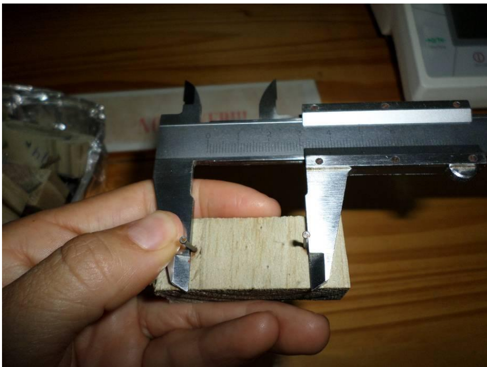
Foto 34. Medición probeta, ensayos de contracción
