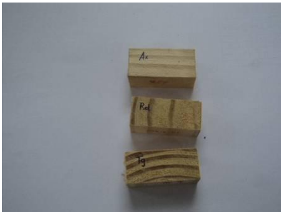
Foto 24. Probetas, cortes radial, tangencial y Axial
