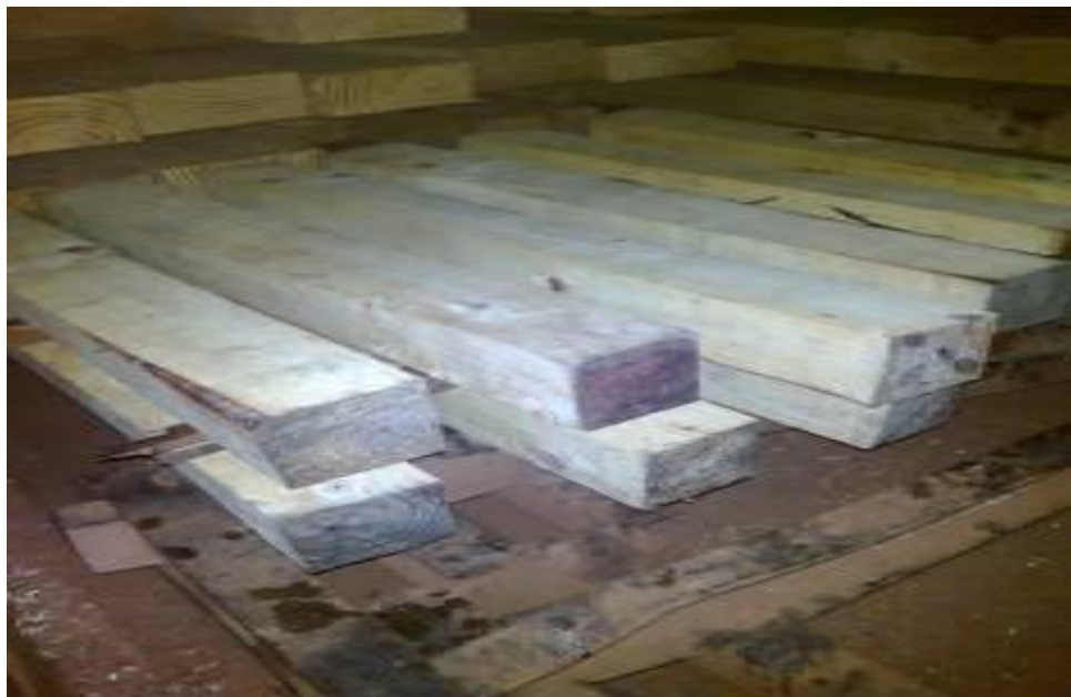
Foto 10. Muestra para ensayos dentro de cámara de secado
