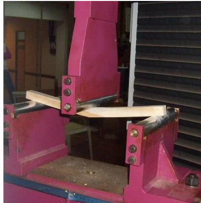
Figura5.2: Esquema de dimensiones (mm) de probeta y aplicación de fuerzas en la determinación de flexión estática.
