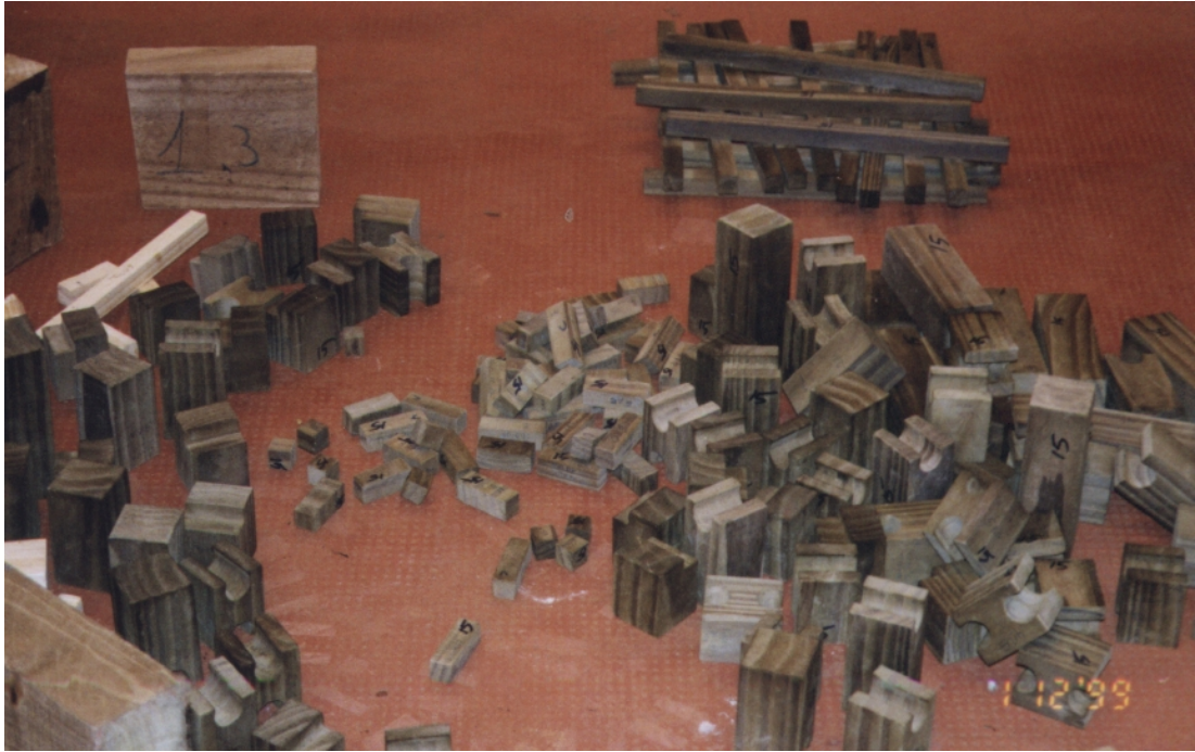
Foto 3.4: Probetas impregnadas, secándose bajo cubierta, Eldorado, 1999.
