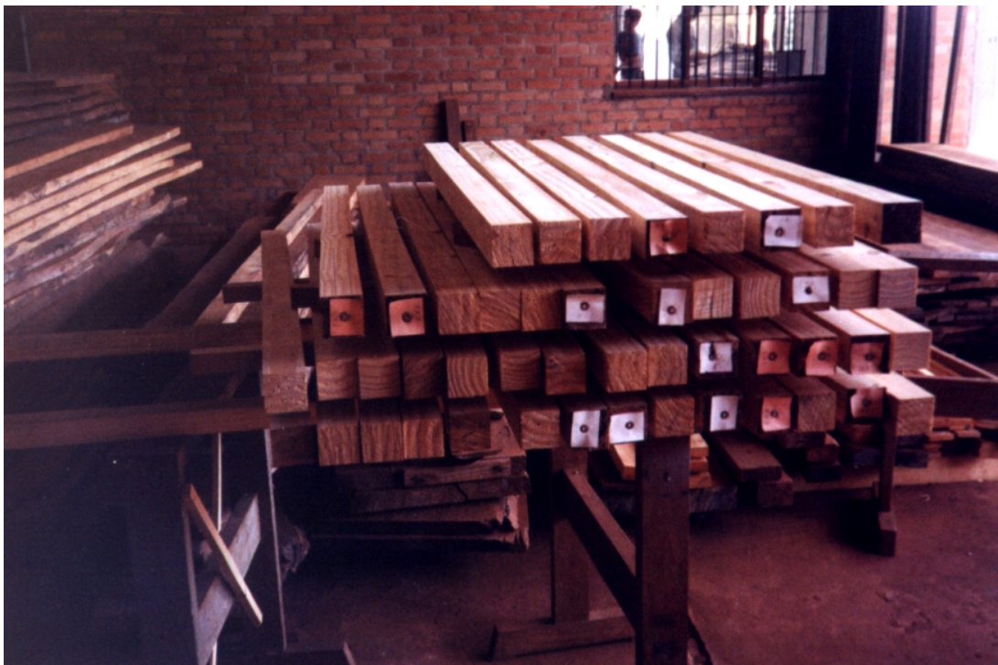
Foto.3.2: Viguetas secándose bajo cubierta, Montecarlo, febrero 1999.
