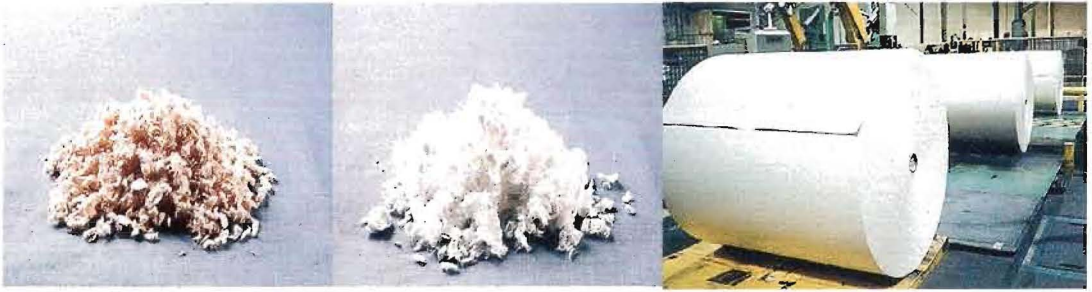
Foto 3: Celulosa sin blanquear, blanqueada y rollo de papel
