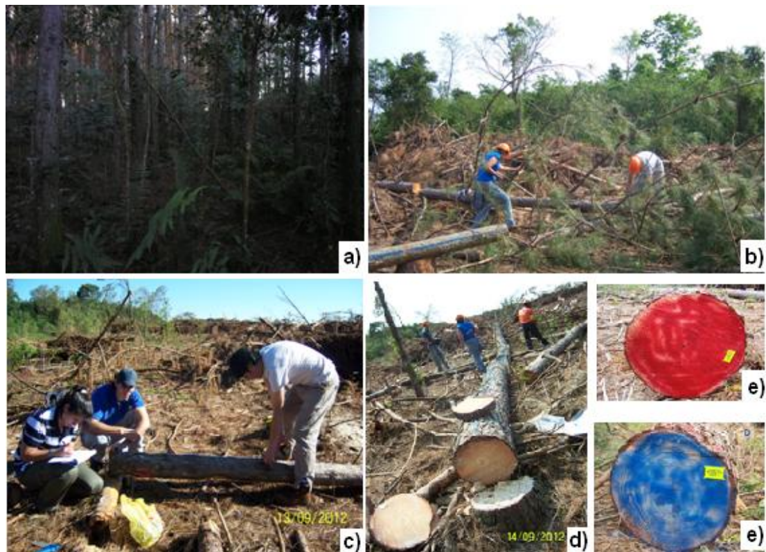
Figura A.2.1: Desarme de árboles. a) vista del ensayo, b) apeo árboles, c) toma de datos, d) extracción de rodajas, e) pintado de los extremos de las trozas.
