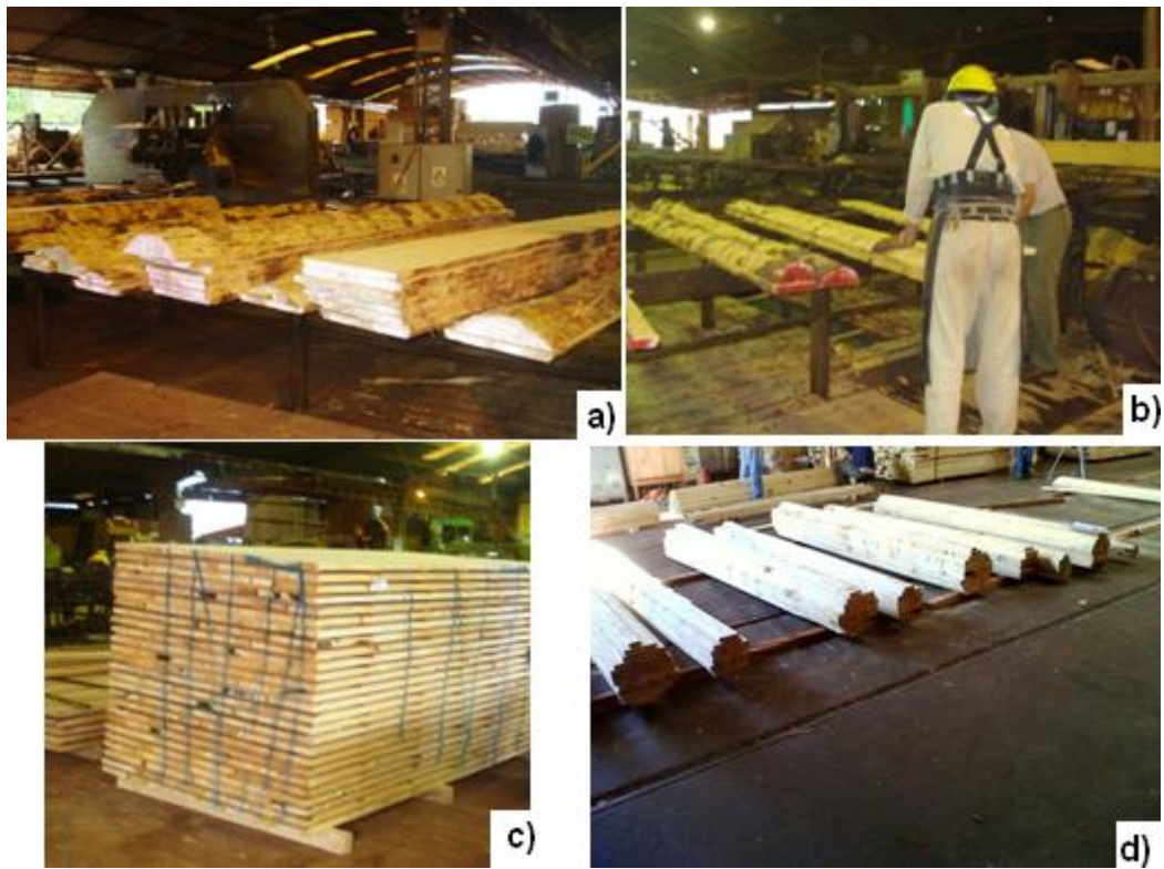
Figura A.2.2: Aserrado. a) y b) proceso de aserrado, c) tablas para llevar al secadero, armado de rollos y d) selección de muestras para ensayos mecánicos.
