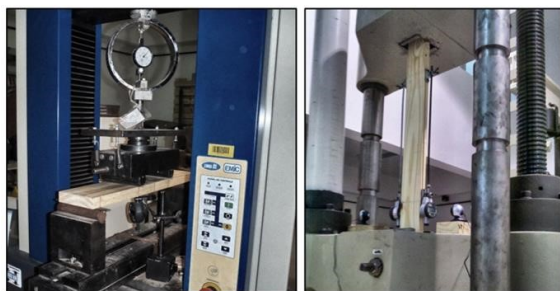
Figura 2. Ensayos estáticos. Izq.: Flexión de plano. Der.: Tracción. Figure 2. Static Testing. Left: Bending test. Right: Tension
